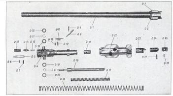
MG 34, Einzelteile: Lauf mit Verschluss
